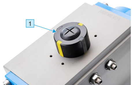
Abb. 3-12 Bedien- und Anzeigeelemente des Schwenkantriebs bar-acturn Längsaufbau = Offenstellung Queraufbau = Geschlossenstellung
