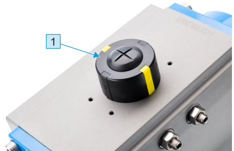
Abb. 3-11 Bedien- und Anzeigeelemente des Schwenkantriebs bar-acturn Längsaufbau = Geschlossenstellung Queraufbau = Offenstellung
