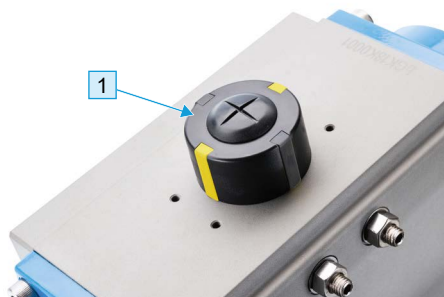
Abb. 3-12 Bedien- und Anzeigeelemente des Schwenkantriebs bar-acturn Längsaufbau = Offenstellung Queraufbau = Geschlossenstellung
